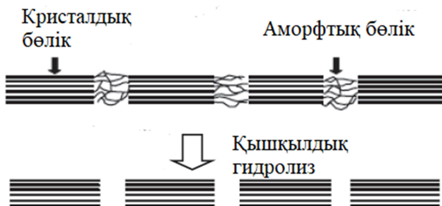
2 сурет – Нанокристалды целлюлозаны алу [5]
