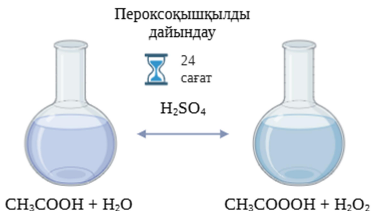
6 сурет – Делигнификациялаушы агентті дайындау процессі
